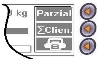
Premendo il tasto freccia a lato della voce SOMMATORIA CLIENTE presente sul display LCD viene aperta la schermata di totalizzazione delle pesate avvenute dal precedente azzeramento di questo totale. Premendo a lungo il tasto si esegue la stampa di tutti i totali per cliente.
