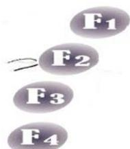
Lo strumento LA688 offre la possibilità di lavorare con più operatori contemporaneamente, modalità di funzionamento OPERATORI selezionata (Par 4.4.1), in questo caso i tasti FUNZIONE F1,F2,F3,F4, diventano i rispettivi tasti operatore.
