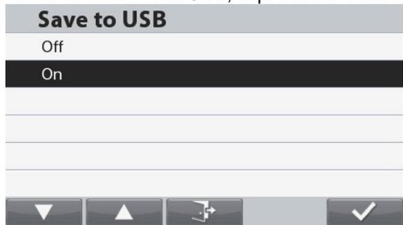
Collegando un flash drive USB per la scala dei valori di peso possono essere memorizzati direttamente sul flash drive USB.
