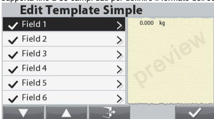
Per formattare un modello, prima selezionare il numero di campo (da 1 a 50). Una finestra contenuta viene visualizzato per il campo selezionato.
