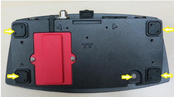
Dopo aver tolto le viti che si fissano l'alloggiamento inferiore con l'alloggiamento superiore capovolgere il modulo terminale. Dopo che sollevare con cautela l'alloggiamento superiore, non rimuovere l'alloggiamento superiore completamente dall'alloggiamento inferiore perché il cavo a nastro overlay terminale tastiera e cavo a nastro display TFT sono ancora attaccati con il circuito stampato principale terminale.
